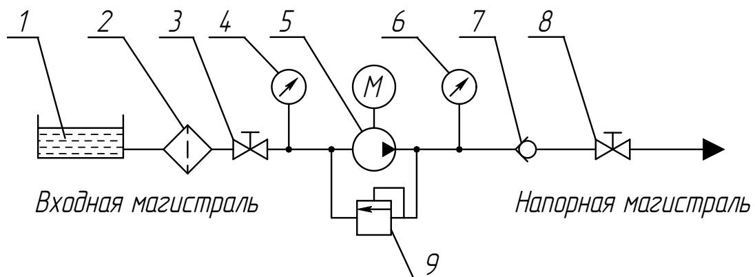
Рисунок 5 – Гидравлическая схема включения агрегата
