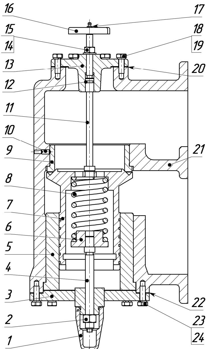
Рисунок 3 – Клапан предохранительный
