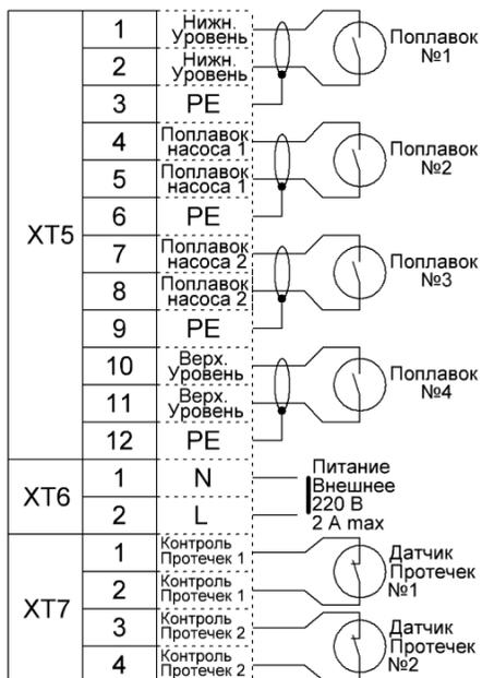
Приложение Б (Схема подключения опциональных сигналов при наличии)
