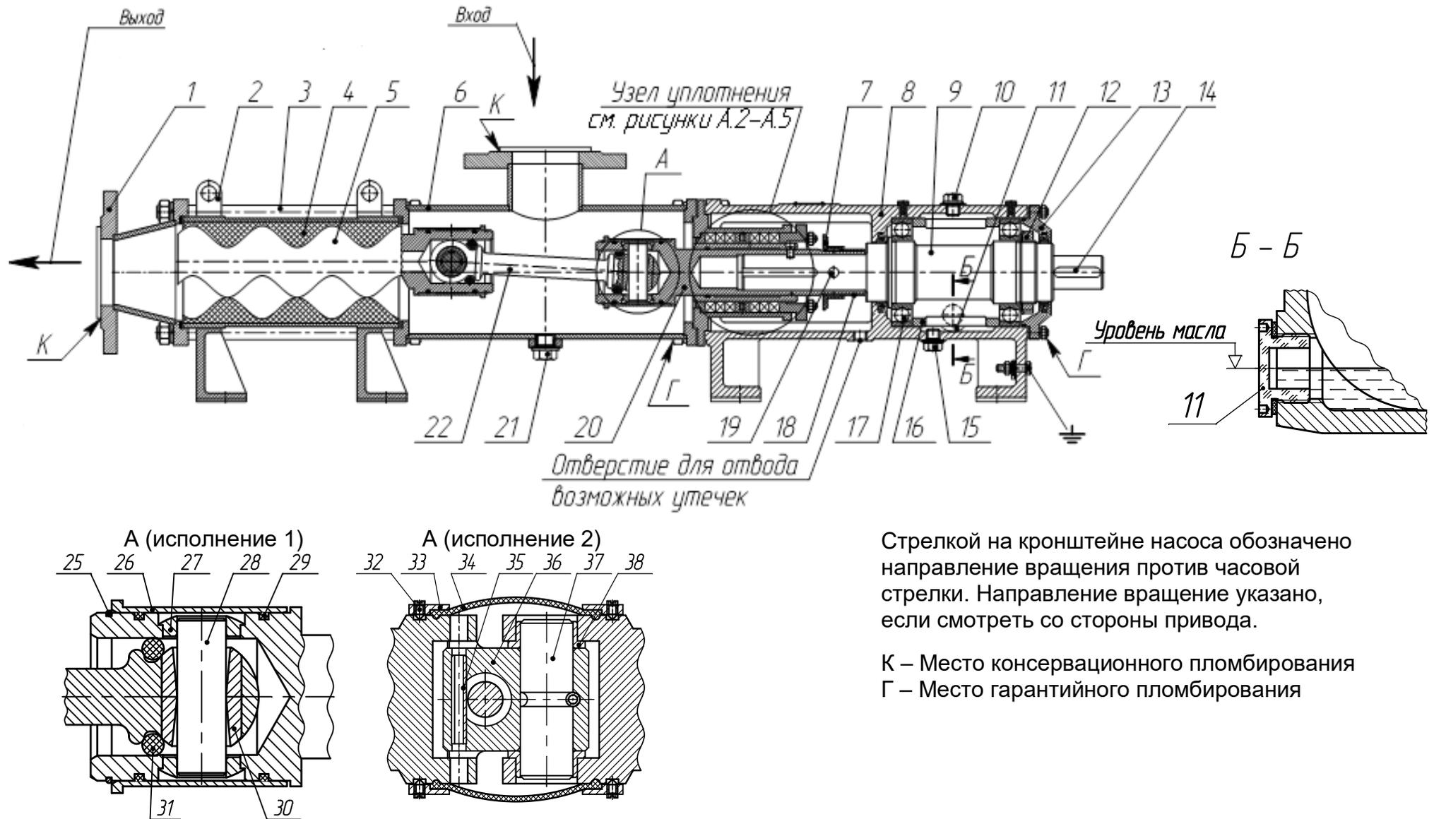
Стрелкой на кронштейне насоса обозначено направление вращения против часовой стрелки. Направление вращения указано, если смотреть со стороны привода.
