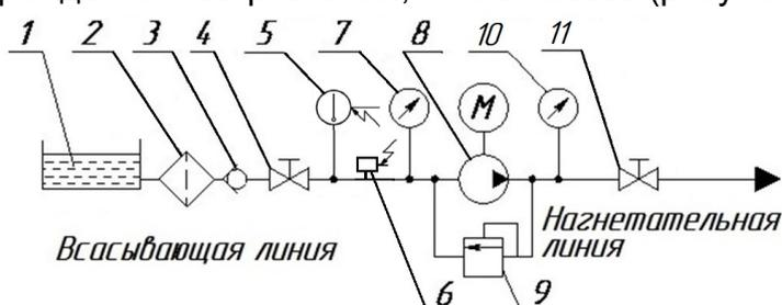
Рисунок 4 - Схема включения агрегата в сеть
