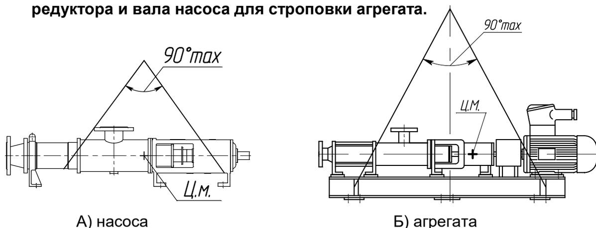
Рисунок 3 – Схема строповки
