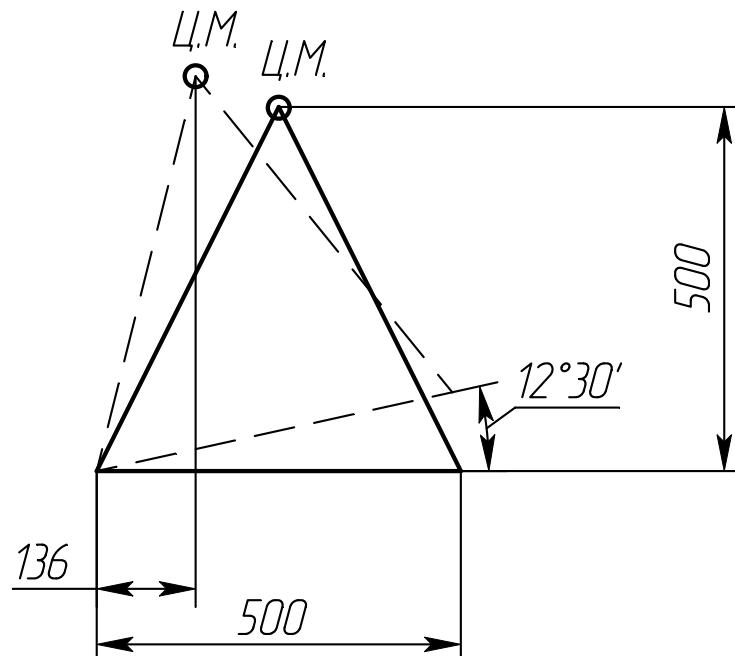
Рисунок 1 - Схема устойчивости агрегата НКСн 150-255.
