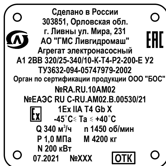
Рисунок 3 – Фирменная табличка (пример оформления)
