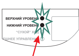
Неправильное срабатывание датчиков уровня
